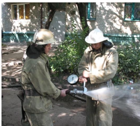
Рисунок 8.6 – Використання трубки Піто для визначення кількості води
