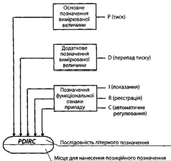
Рис. 7.2 – Принцип побудови умовного зображення приладу автоматики
