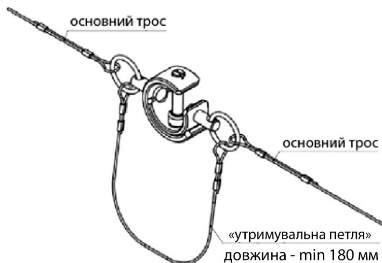
Рис. 5.4 – Монтаж тросової системи детектора з термочутливим замком
