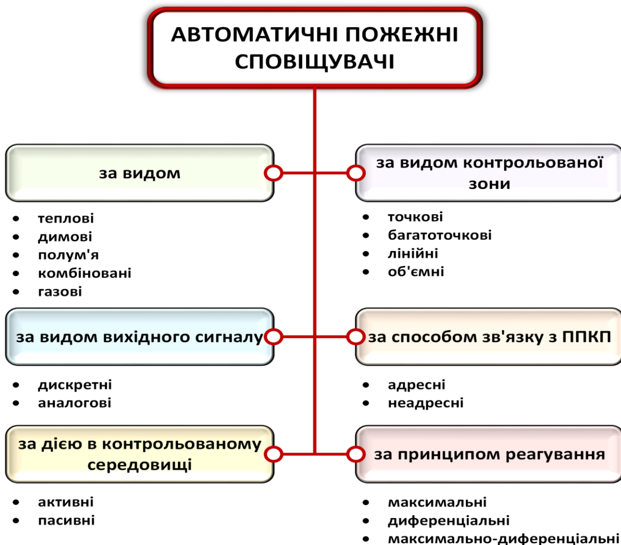
Рис. 2.1.1.1 Класифікація автоматичних пожежних сповіщувачів
