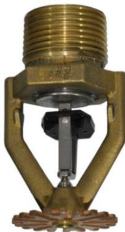
Рис. 2.2.1.3.1. Спринклерний зрошувач Victaulic V4601 з легкоплавкими сплавами, розеткою вниз
