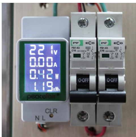
Рис.10.2. Зовнішній вигляд елементів стенду: 1 – прилад для вимірювання електричного струму на напруги; 2 – термопара для вимірювання температури
