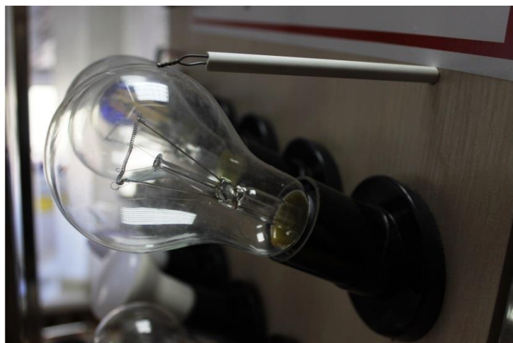
Рис.10.2. Зовнішній вигляд елементів стенду: 1 – прилад для вимірювання електричного струму на напруги; 2 – термопара для вимірювання температури
