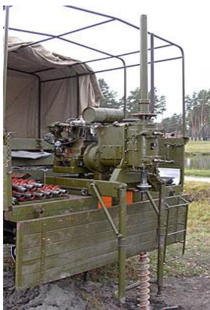
Рис.10.1 – Установка видобутку ґрунтових вод (УДВ-15) в режимі буріння
