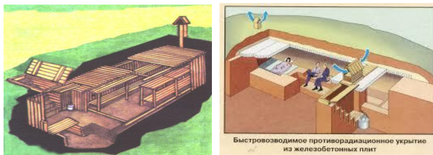
Рис. 10. Швидкоспоруджувана захисна споруда цивільного захисту.
