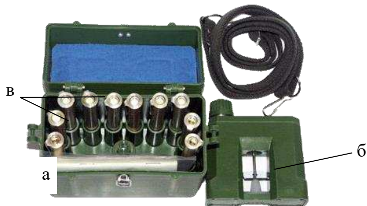
Рис. 17. Комплект індивідуальних дозиметрів ІД-1: а – загальний вигляд комплекту; б – зарядний пристрій ЗД-6; в – дозиметр
