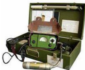
Рис. 15. Військовий дозиметричний прилад ДП-5В
