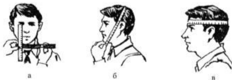
Рис. 23. Заміри голови при підбиранні розміру лицьової частини протигазу.
